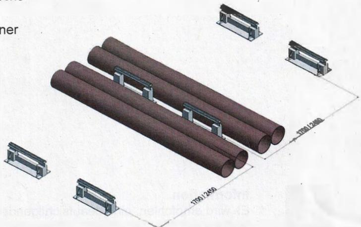
3. Die vier mittleren Abschnitte positionieren, Heben Sie diese mit einem Minimum von 4 Personen schieben Sie die vier kleinen Stützen bis sie sich in der richtigen Position befinden
